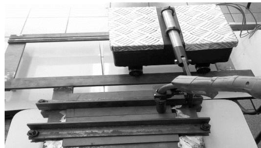
**Figura 2:** Dispositivo de soldagem construído pelos bolsistas.
