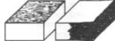
CORROSÃO POR ESFOLIAÇÃO
