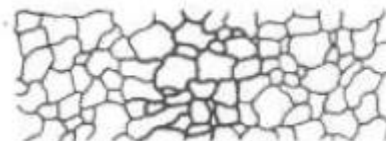
CORROSÃO INTERGRANULAR (MICROGRAFIA)
