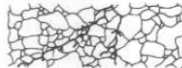
CORROSÃO INTRAGANULAR (MICROGRAFIA)
