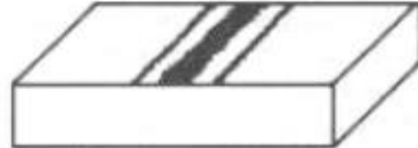
CORROSÃO EM TORNO DE SOLDA
