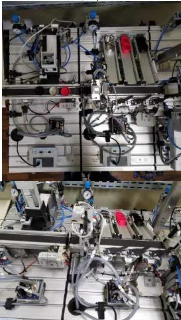
Figura 36 - Planta da FESTO, com peça fabricada no IF maker, acoplada no final da esteira de separação.
