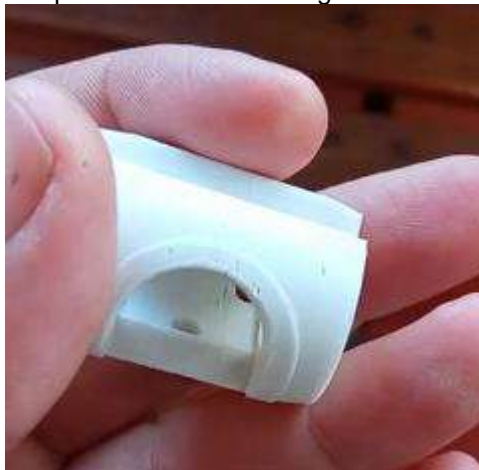
Figura 32 - Peça mecânica para fechamento do Agnoline fabricada via prototipagem 3D
